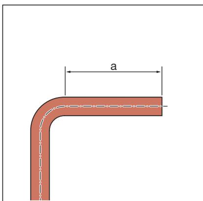
Los tubos de cobre de los tamaños d 12, 15, 18, 22 y 28 se pueden curvar en frío con dispositivos de flexión convencionales (radio mínimo de  $3,5 \times d$ ).
