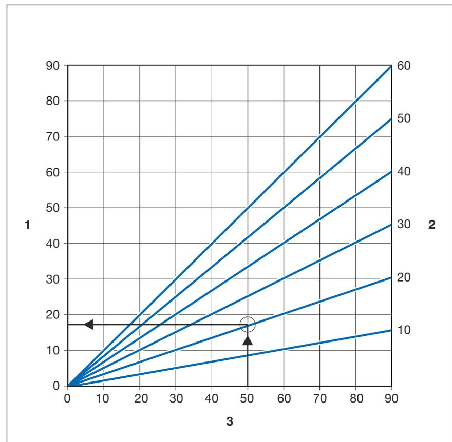
**Fig. 2: Dilatación longitudinal de los tubos de cobre**
