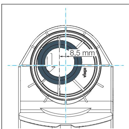
► Gire el empalme para desplazar el desagüe excéntricamente hasta 8,5 mm.
