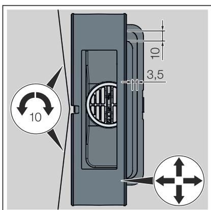
► Alinear el perfil para canaleta de ducha y la pieza de compensación de altura horizontalmente.
