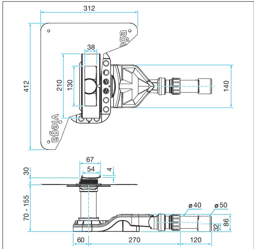
Fig. 4: Dimensiones del cuerpo base del modelo básico
