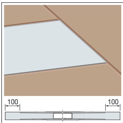
El perfil para canaleta de ducha se puede recortar en los extremos de la zona de descarga hasta 100 mm.
