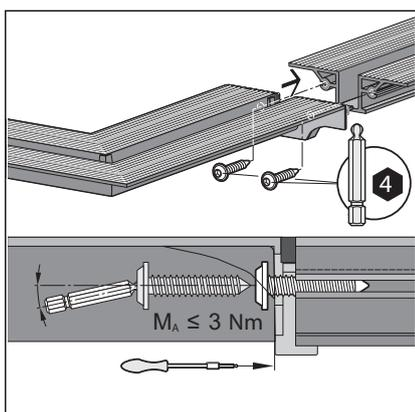
► Atornille la pieza de unión de 90° recta en el perfil.
