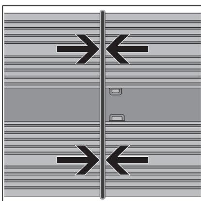
⇒ La pieza de unión de 90° está montada correctamente si la junta queda **ligeramente** apretada.
