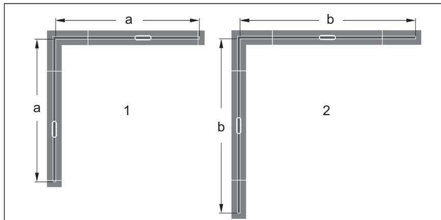
Fig. 1: Opciones de montaje con piezas de unión de 90° para variante en L
