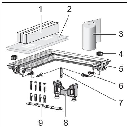
Fig. 3: Pieza de unión de 90°, volumen de suministro
