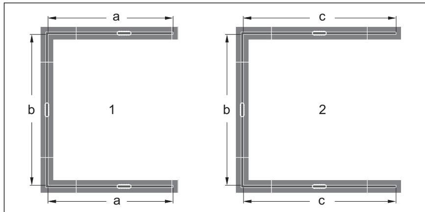
Fig. 2: Opciones de montaje con piezas de unión de 90° para variante en U
