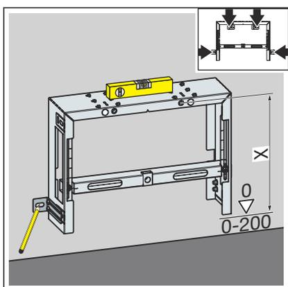
■ Die Bauhöhe des Bidet-Blocks nach bauseitiger Kennzeichnung der Oberkante Fertigfußboden einstellen.
