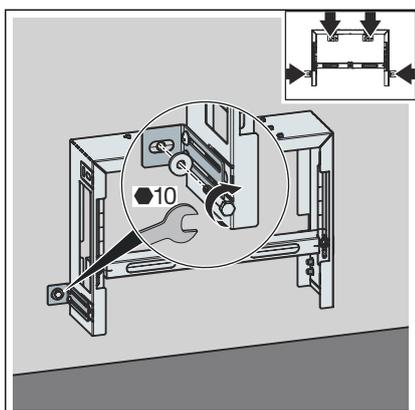
■ Den Bidet-Block über die Wandhalterungen mit einem Maulschlüssel (SW 10) festschrauben.
