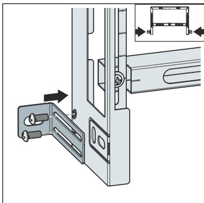
■ Die Metallwinkel am Bidet-Block anschrauben.
