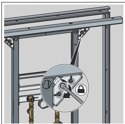
■ Das Element mit Prevista Dry Plus-Schienenverbindern befestigen.
