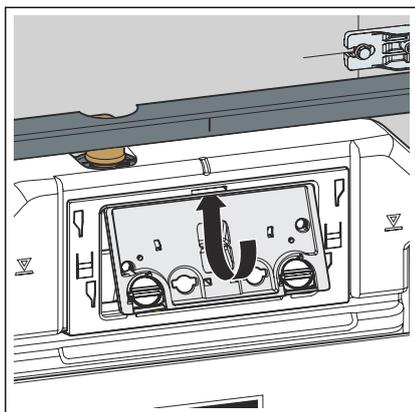
► Die Bauschutzplatte in den Spülkasten einsetzen.
