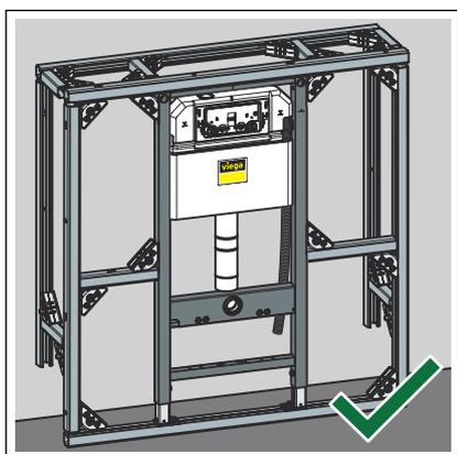
□ Das WC-Element ist in der Prevista Dry Plus-Vorwandkonstruktion befestigt.
