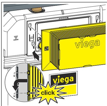
► Den Revisionsschacht auf die Bauschutzplatte stecken.
