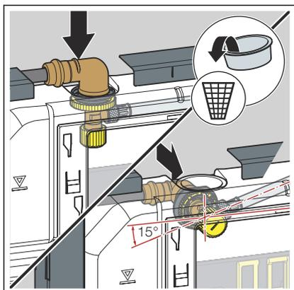
**INFO!** Beim UP-Spülkasten 3H kann das Eckventil von oben oder von hinten angebracht werden.
