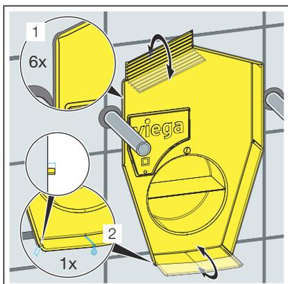
**INFO!** Das Überstehen der letzten Lamelle an der Unterseite der WC-Anschlussbox verhindert das Eindringen von Leckwasser hinter die Wand.
