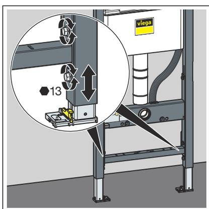
► Die FüÙe des Elements mit einem Maulschlüssel (SW 13) lösen.
