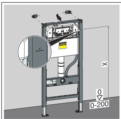
► Die Bauhöhe des Elements nach bauseitiger Kennzeichnung der Oberkante Fertigfußboden einstellen.
