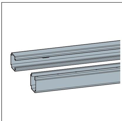
Die Montageschiene aus verzinktem Stahl ist 5 m lang, einseitig geöffnet und alle 30 cm für die Wand- und Bodenmontage gelocht.
