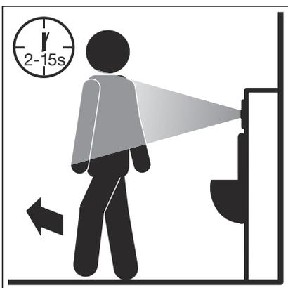
Es kann auch manuell eine Spülung ausgelöst werden, indem eine Hand kurz vor den Sensor gehalten wird.
