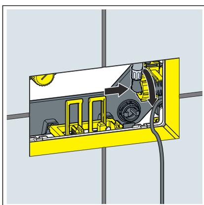
► Den Flexschlauch am Füllventil anschließen.
