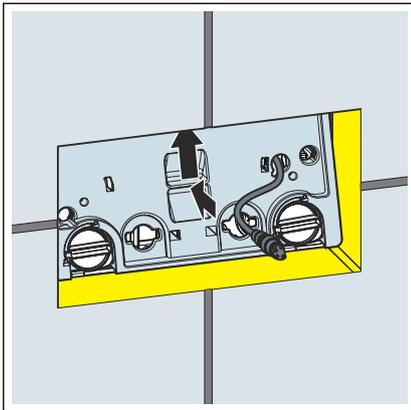
► Die Bauschutzplatte in den Spülkasten einsetzen.
