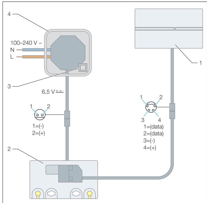
**Abb. 2: Anschlussschema, Netzteil, WC-Betätigungsplatte für Prevista**
