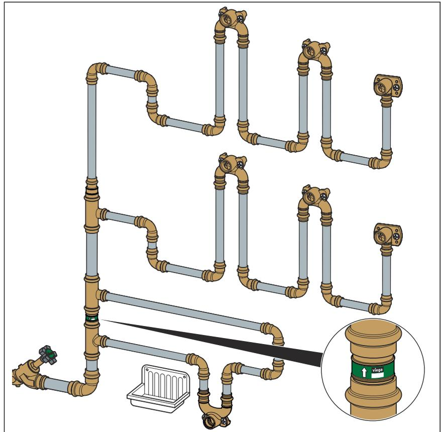
**Abb. 1: Einbausituation Einpressdüse**
