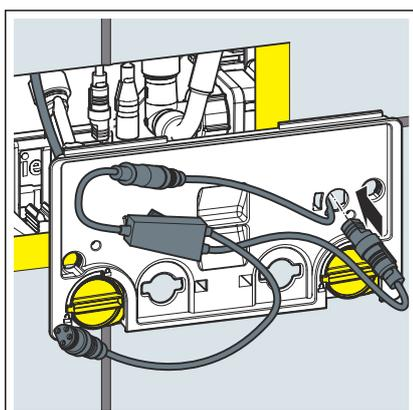
► Das lange Ende des Anschlusskabels durch die Bauschutzplatte zurück in den Spülkasten führen.
