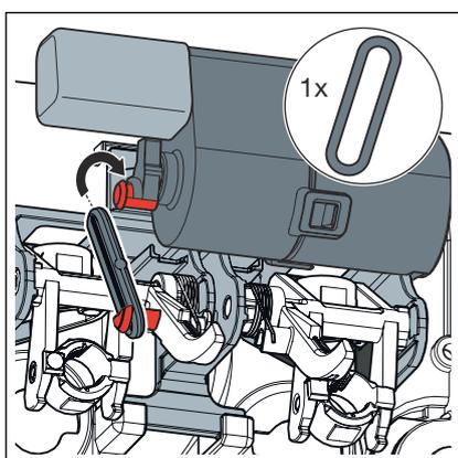
► Den Bügel der Mechanik und die Antriebseinheit mit der Öse verbinden.
