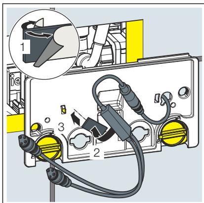
► Die Schutzfolie des Klebestreifens lösen.
