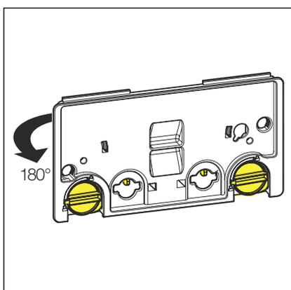
► Die Bauschutzplatte um 180° drehen.
