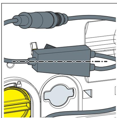
► Das Anschlusskabel auf der Bauschutzplatte positionieren.
