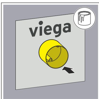
► Die Abdichtungsmanschette aufschieben und in die Verbundabdichtung einarbeiten.
