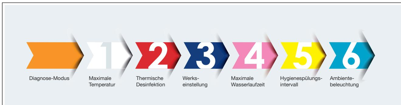
Durch langes Drücken des Bedienelements wird das Menü aufgerufen. Solange das Bedienelement gedrückt gehalten wird, werden nacheinander die unterschiedlichen Menüfunktionen angezeigt, indem der LED-Leuchtring unterschiedliche Farben annimmt. Jede Farbe steht für eine andere Menüfunktion.
