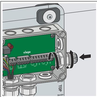
► Die Kabelverschraubung rechts unten einsetzen.
