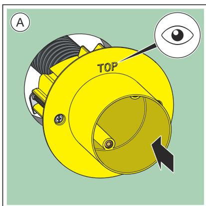
► Die Unterputzdose mit dem Ausgang nach oben in Richtung Dusch-einheit einsetzen. Kennzeichnung TOP beachten.
