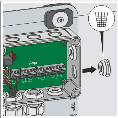
► Den Membranstutzen rechts unten aus der Anschlussdose entnehmen und entsorgen.
