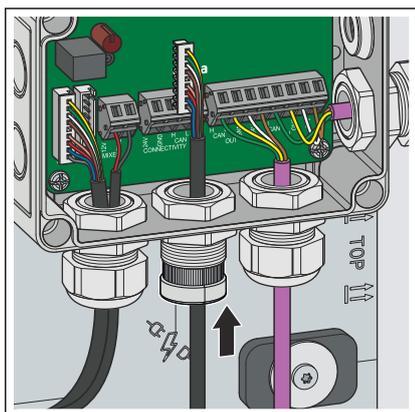
► Das Kabel des Bedienelements durch die mittige Kabelverschraubung unten an der Anschlussdose führen.
