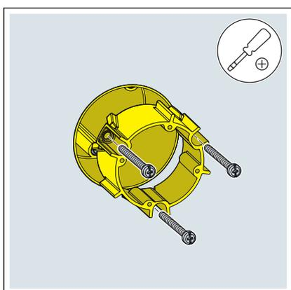
► Den Adapter in die Unterputzdose einsetzen und festschrauben.
