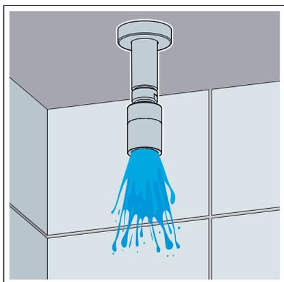
□ Die Komponenten der Duscheinheit füllen sich mit Wasser, anschließend tritt Wasser aus dem Duschkopf aus.
