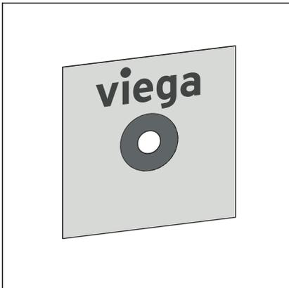
Die Abdichtungsmanschette dichtet das Loch ab, in dem das Bedienelement einmontiert ist.
