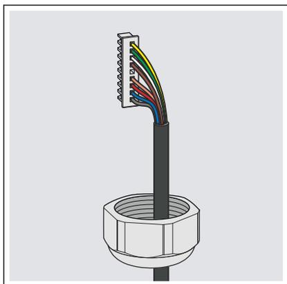
► Den Stecker des Bedienelements durch die Druckschraube führen.
