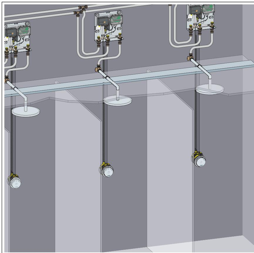
**Abb. 2: Montage in einer Reihenduschanlage**
