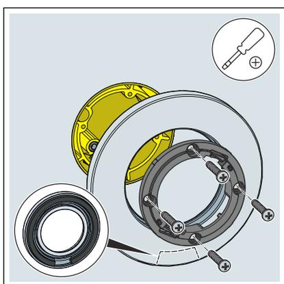
► Die Abdeckrosette so aufsetzen, dass die Aussparung des Dichtelements nach unten zeigt.
