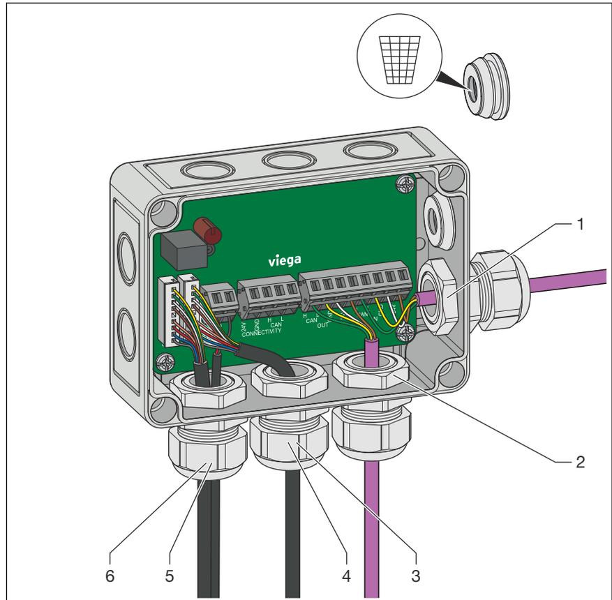
**Abb. 14: Kabeleingänge AquaVip-Duscheinheit elektronisch zentral – AquaVip-Interface**
