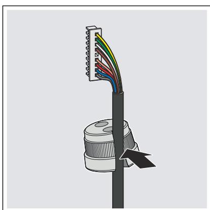
► Das Kabel durch den Schlitz in die Kabeldurchführung drücken.
