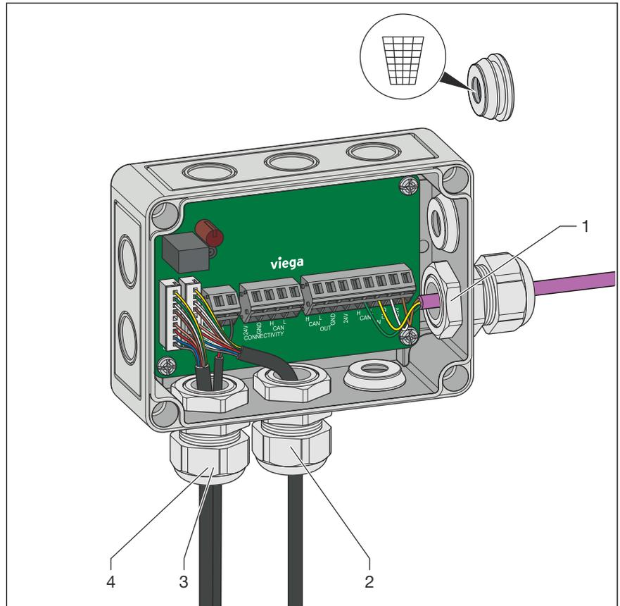
**Abb. 12: Kabeleingänge AquaVip-Duscheinheit elektronisch zentral – Einzelanwendung**
