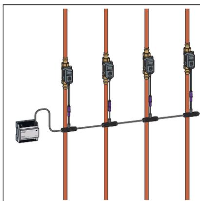
**Abb. 5: AquaVip-Netzteil und x AquaVip-Zirkulationsreguliertventile, Spannungsversorgung mit AquaVip-T-Verbindern**
