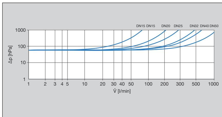
Abb. 3: Leistungsdiagramm Druckverlust RV Press-/Gewindeanschluss
