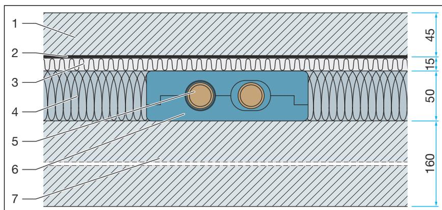
**Abb. 4: Beispiel einer Estrichkonstruktion mit dem Kreuzungs-T-Stück**
