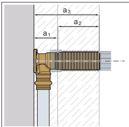
Die Stärke des Wandaufbaus ist abhängig von der verwendeten Wandscheibe. Mit einer Hahnverlängerung ist eine Verlängerung um maximal 70 mm möglich.
