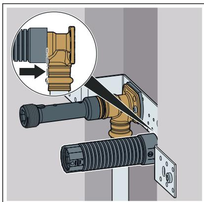
**HINWEIS!** Die Dichthülse so weit aufschrauben, dass sich Dichthülse und die Rohreinführung der Wandscheibe berühren. Die Dichthülse muss fest auf der Wandscheibe sitzen.
