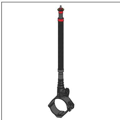
Die Einbaugarnituren sind mit einer auf die Geopress-Anbohrarmaturen abgestimmten Hülsrohrglocke ausgestattet. So wird das Eindringen von Schmutz in das Hülsrohr verhindert und der korrekte Sitz auf der Anbohrarmatur gewährleistet. Die Einbaugarnituren sind stufenlos verstellbar und in jeder Stellung selbsttragend.
