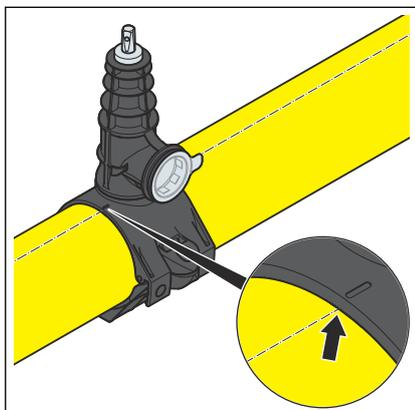
Das Modell ist mit einer Markierung zur Ausrichtung auf der Versorgungsleitung versehen.
