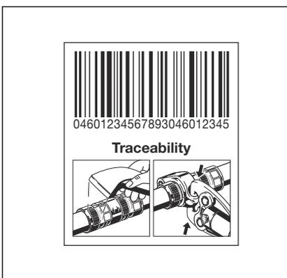
Die Lage neu verlegter Leitungen und Anschlussleitungen, einschließlich detaillierter Angaben über Rohrleitungsteile, muss dokumentiert und regelmäßig aktualisiert werden. Der Traceability-Code auf dem Pressverbinder ermöglicht die Rückverfolgung jedes Pressverbinders und erleichtert die Dokumentation in Bestandsplänen. Nach der Verpressung wird der Aufkleber mit dem Traceability-Code entfernt und zeigt so die erfolgte Verpressung an.
