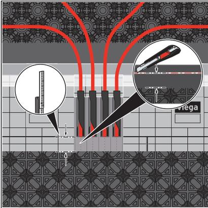
**HINWEIS!** Um Schallbrücken zu vermeiden, verlegen Sie das Türdurchgangselement nicht über die aufgeschnittenen Dämmschläuche.
