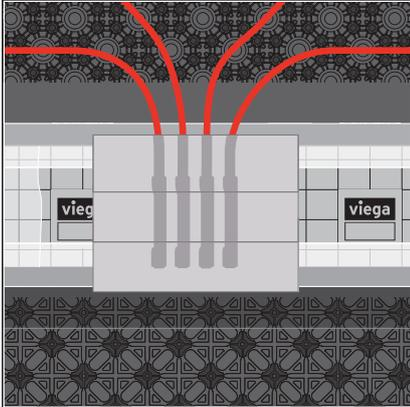
**HINWEIS!** Achten Sie darauf, dass beim Abkleben keine Hohlstellen zwischen den Rohrleitungen entstehen.
