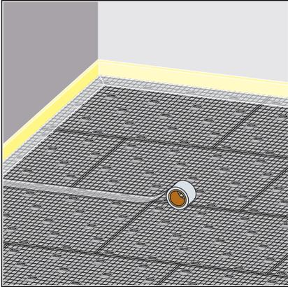
► Alle Stoßstellen mit Klebeband abkleben.
