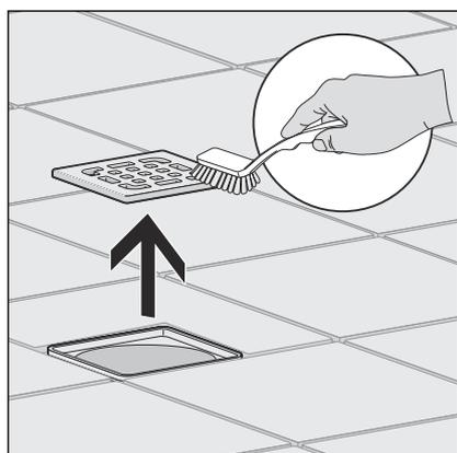
► Rost entnehmen und reinigen.
