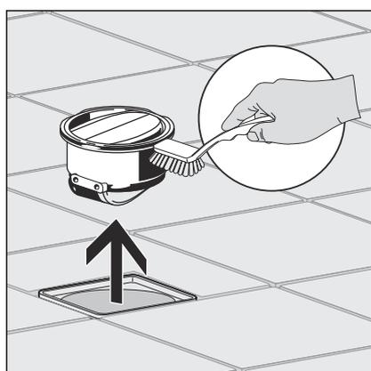
► Geruchverschluss entnehmen und reinigen.
