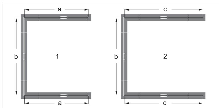
**Abb. 2: Einbaumöglichkeiten mit Verbindungsstücken 90° für U-Variante**
