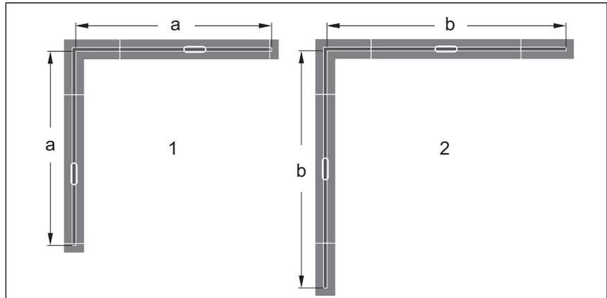
**Abb. 1: Einbaumöglichkeiten mit Verbindungsstücken 90° für L-Variante**
