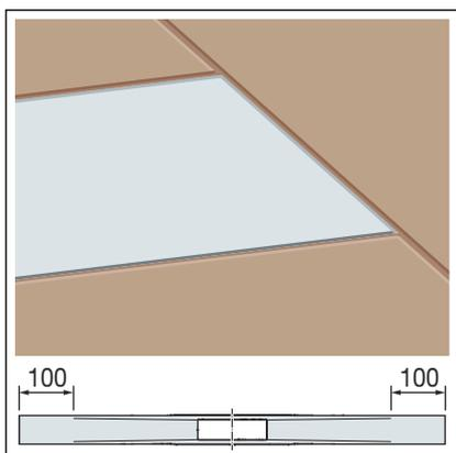
Das Duschrinnen-Profil kann an den Enden der Auslaufzone bis zu 100 mm gekürzt werden.
