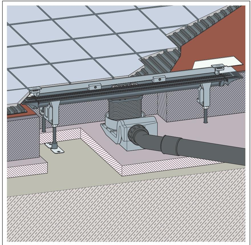
**Abb. 9: Schema einer Verbundabdichtung**
