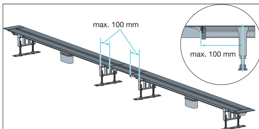
Abb. 18: Abstand zwischen Befestigungspunkt und Fuß = max. 100 mm
