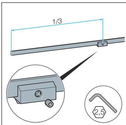
► Die Stegroststütze am Stegrost befestigen.
