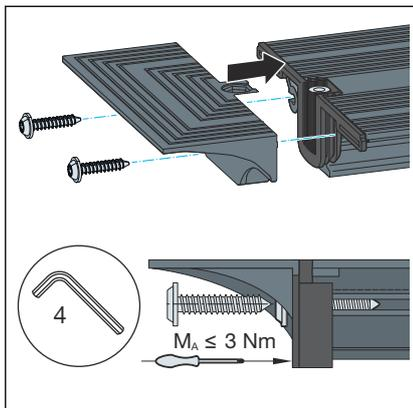
■ Die Verschlusskappe gerade an das Profil anschrauben.
