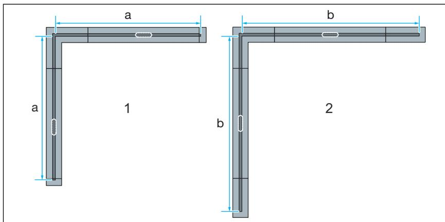
**Abb. 4: Einbaumöglichkeiten mit Verbindungsstücken 90° für L-Variante**
