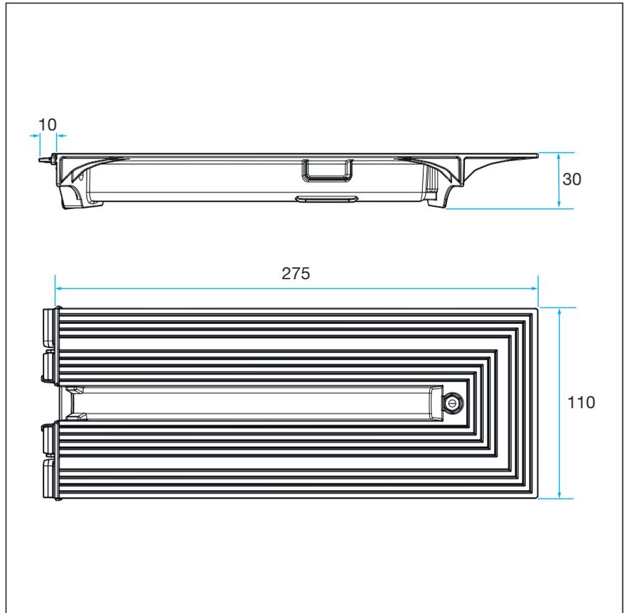
**Abb. 15: Abmessungen Endverschlussstück**
