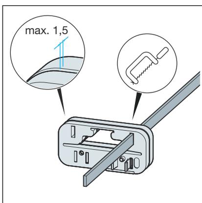
► Bei Bedarf den Stegrost mit der Handsäge kürzen und entgraten. Zum Kürzen keine Trennscheibe bzw. keinen Winkelschleifer verwenden.
