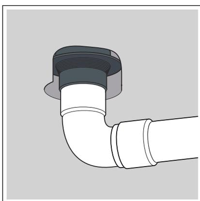
**HINWEIS!** Zum Anschluss an ein Rohr aus Guss muss ein geeigneter Übergang verwendet werden.
