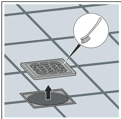
► Den Rost entnehmen und reinigen.
