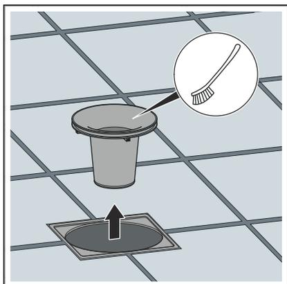
► Das Tauchrohr entnehmen und reinigen.
