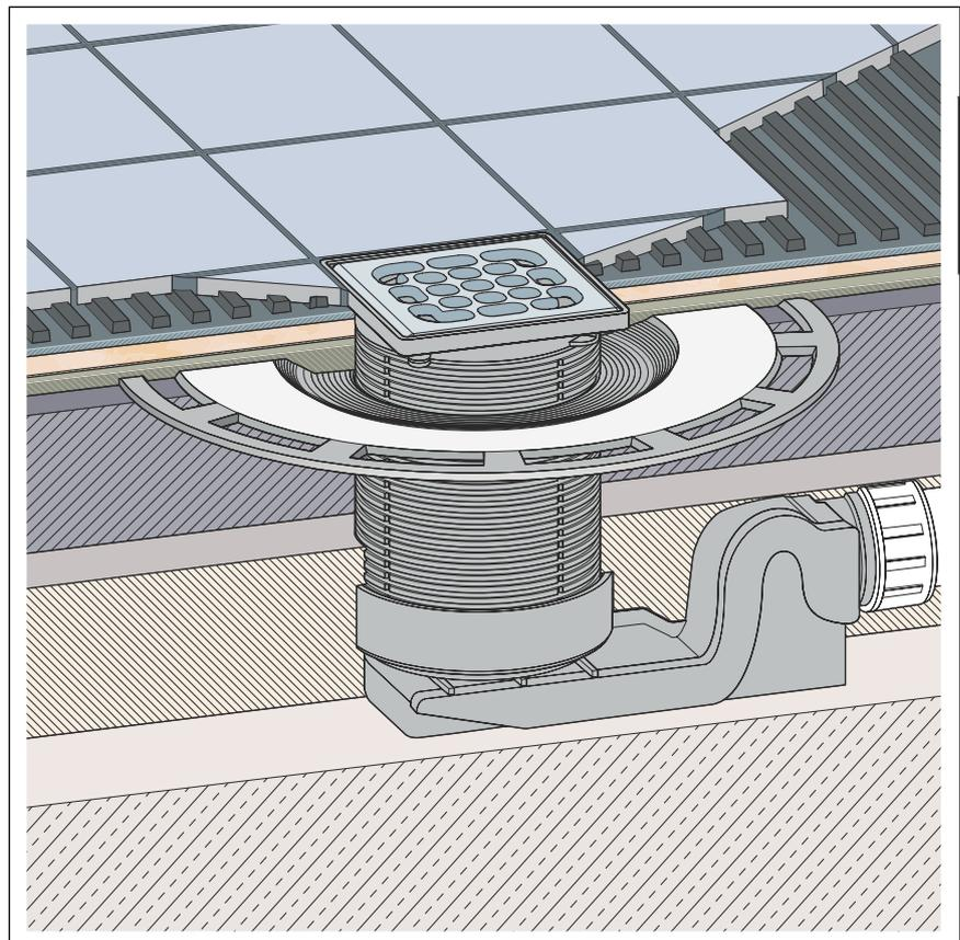
Abb. 4: Schema einer Verbundabdichtung
