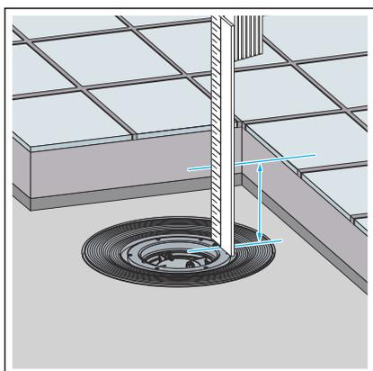
Zum Abschluss der Montage des Ablaufs den Aufsatz mit dem Rost montieren. Gehen Sie dazu wie folgt vor:
