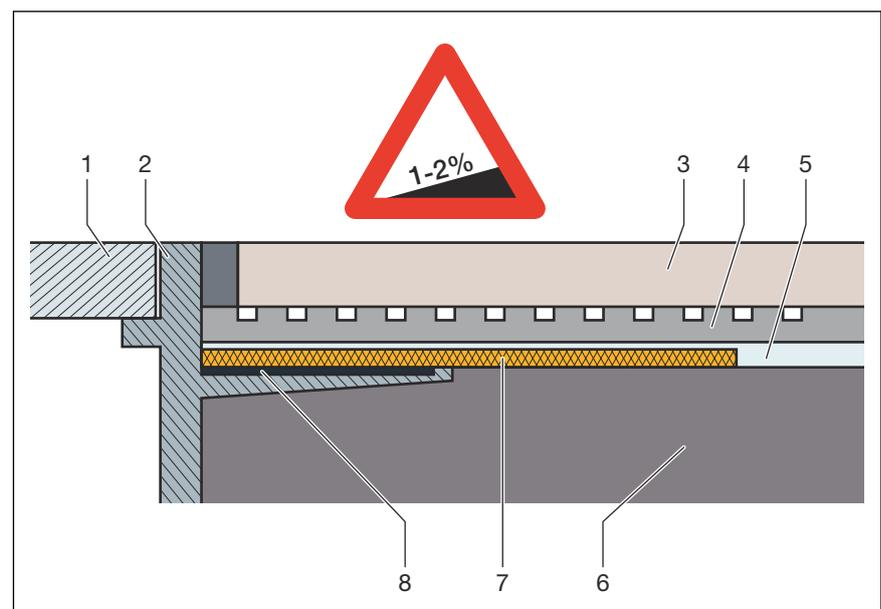
**Abb. 5: Aufbauschema der Verbundabdichtung – Estrichgefälle min. 1–2 %**
