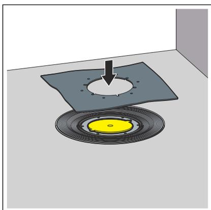
**INFO!** Die Viega Abdichtungsmanschette hat zwei unterschiedlich beschichtete Seiten. Eine Seite ist mit Bitumen und eine Seite ist mit EPDM beschichtet. Wenn die weitere Abdichtung mit Bitumen-Abdichtungsbahnen erfolgt, muss die Abdichtungsmanschette mit der Bitumen-Seite nach oben verwendet werden. Wenn EPDM-Abdichtungsbahnen verwendet werden, muss die EPDM-Seite nach oben zeigen.
