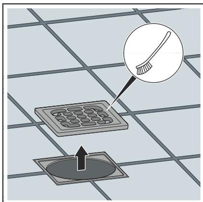
► Den Rost entnehmen und reinigen.
