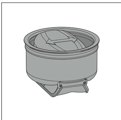
Advantix-Abflüsse können mit einer zusätzlichen Geruchssperre ausgestattet werden, die den Ablauf auch dann geruchsicher verschließt, wenn das Sperrwasser im Geruchverschluss ausgetrocknet ist. Geruchsbelästigungen werden so auch bei selten benutzten Abflüssen verhindert. Geruchssperren finden Sie im Katalog.
