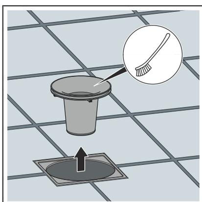
► Das Tauchrohr entnehmen und reinigen.
