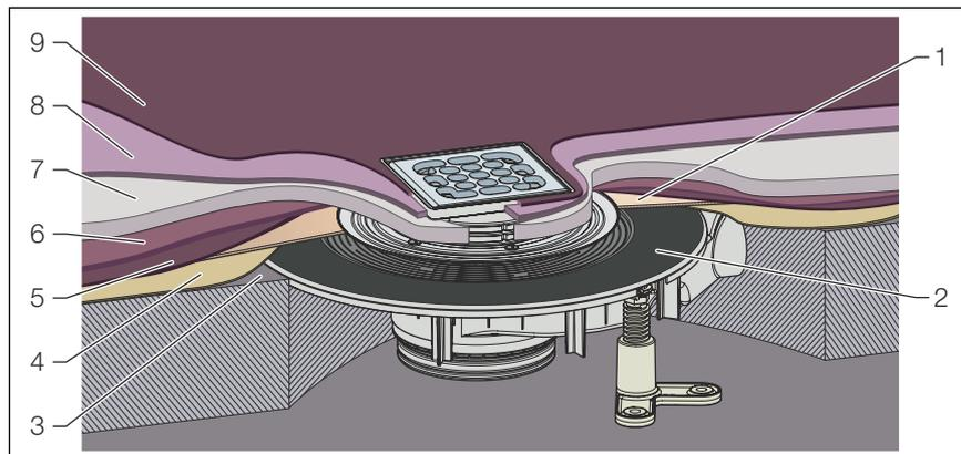
Abb. 12: Schichtaufbau der Verlaufsbeschichtung
