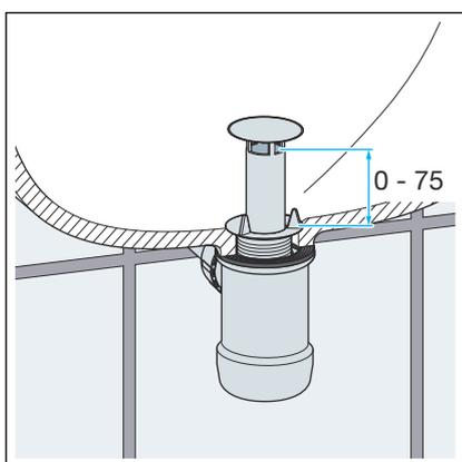
► Der Wasserstand ist um bis zu 75 mm höhenverstellbar.
