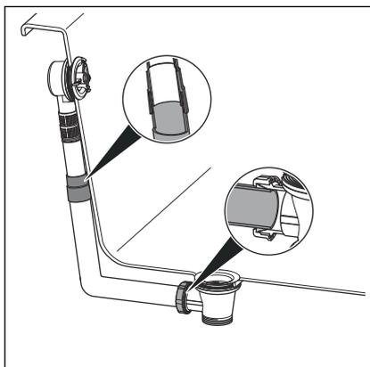
**HINWEIS!** Wenn die Rohre bei Rohrverbindungen nicht weit genug ineinander stecken, werden die Verbindungen undicht. Halten Sie deshalb bei jeder Verbindung eine minimale Einstecktiefe von 15 mm ein.
