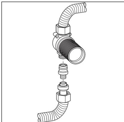
Um den Rohrunterbrecher anzuschließen:
