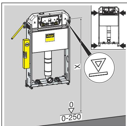
► Die Bauhöhe des WC-Blocks nach bauseitiger Kennzeichnung der Oberkante Fertigfußboden einstellen.
