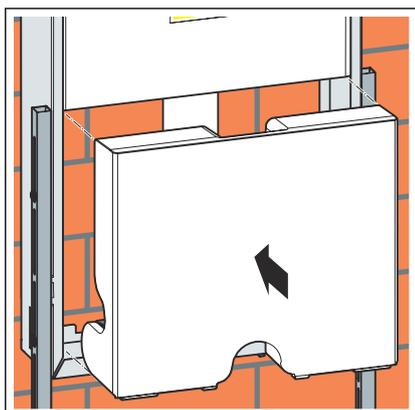
► Den Schutzkasten einsetzen.
