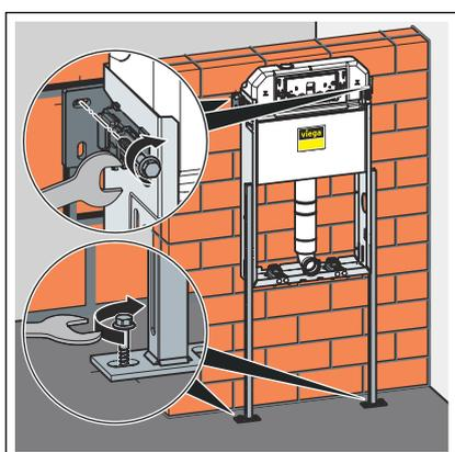
► Den WC-Block und die Standkonsole mithilfe der Wandhalterungen mit einem Maulschlüssel festschrauben.
