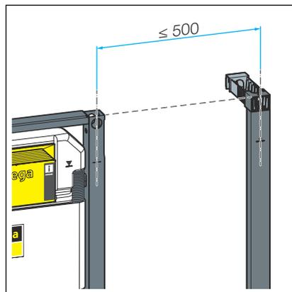
Abb. 4: Maximalabstand zwischen Prevista Dry-Zwischenkonsole und Prevista Dry-Element
