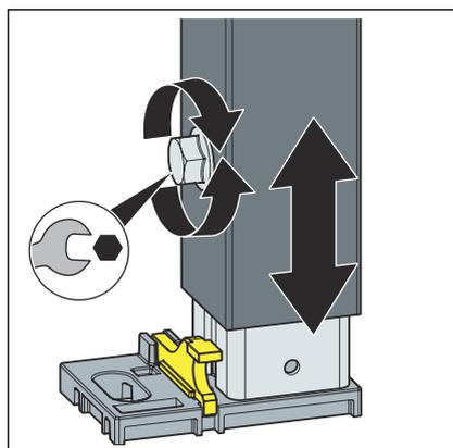
➤ Die Füße des Elements mit einem Maulschlüssel lösen.
