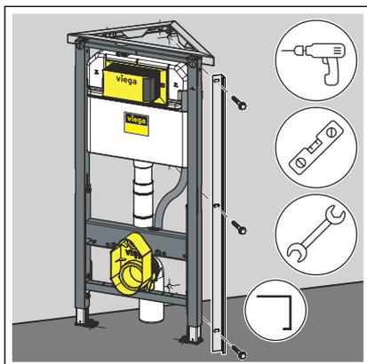
► Das Montageprofil 90° bündig an der Wand montieren.
