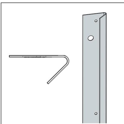
Montageprofil 45° (Modell 8077) für die Beplankung an freistehender Wand und für Eckmontage links und rechts neben dem Element.
