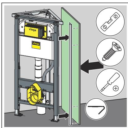
► Das Montageprofil 45° bündig an der ersten Ecke der Eck-Einbauhilfe montieren.
