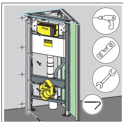
► Das Montageprofil 45° bündig an der zweiten Ecke der Eck-Einbauhilfe montieren.
