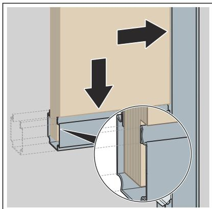
**INFO! Die Schichtholzplatte nur in die offene Schienenseite einsetzen.**
