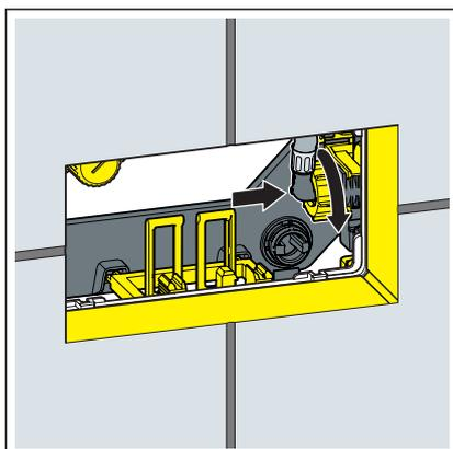
► Den Flexschlauch am Füllventil anschließen.
