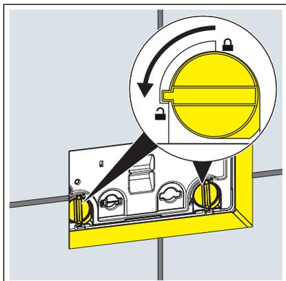
► Die Verriegelung der Abdeckplatte um 90° gegen den Uhrzeigersinn drehen.
