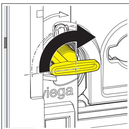
► Die Haltebolzen um 90° im Uhrzeigersinn drehen.
