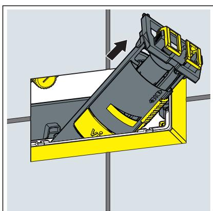
► Das Ablaufventil durch die Revisionsöffnung entnehmen.
