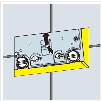
► Die Abdeckplatte in den Spülkasten einsetzen.
