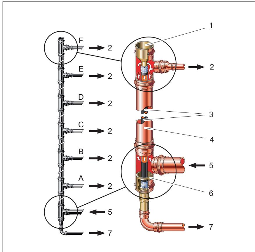
Abb. 5: Funktionsprinzip Smartloop-Inlinertechnik
