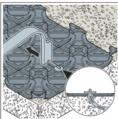
► Die Setzhilfe seitlich vom eingesetzten Fixierhaken schieben.
