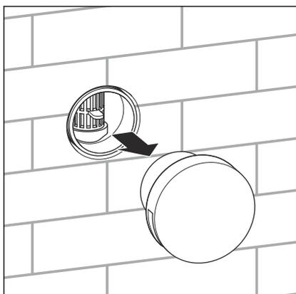
➤ Einsatz mit einer Wasserpumpenzange aus dem Gehäuse herausziehen.
