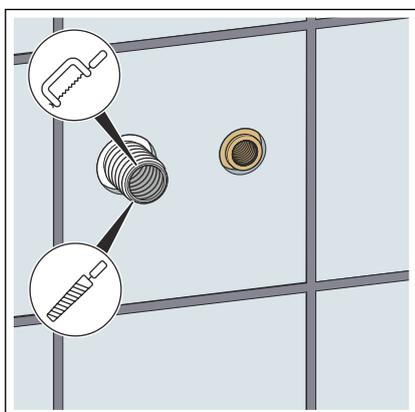
► Den UP-Gerätesiphon mit einer Säge auf 21–22 mm von der Vorderkante der gefliesten Wand kürzen.
