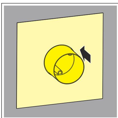
► Die Dichtmanschette aufschieben und in das Abdichtungskonzept einarbeiten.
