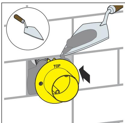
► Die Anschlussdose mit Schnellmörtel festsetzen.
