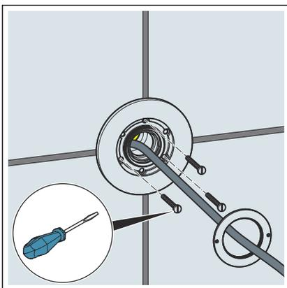
► Die Abdeckrosette mit den ausgesuchten Schrauben befestigen.
