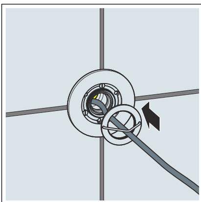
► Den Abdeckring mit der Einschraubhilfe einschrauben.
