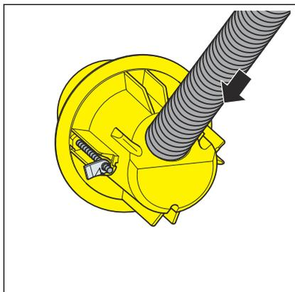
► Das Leerrohr so einsetzen, dass innen zwei Ringe zu sehen sind.
