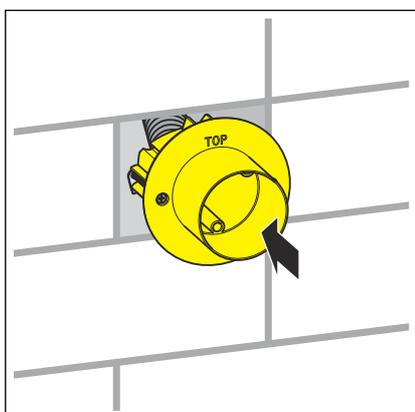
► Die Anschlussdose in die Aussparung einsetzen.
