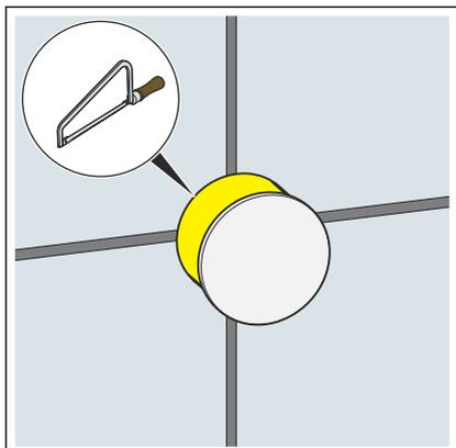
► Die Anschlussdose flächenbündig abschneiden oder sägen.
