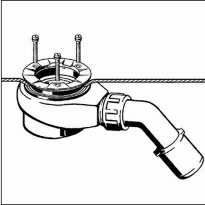
► Schrauben von Hand einsetzen.
