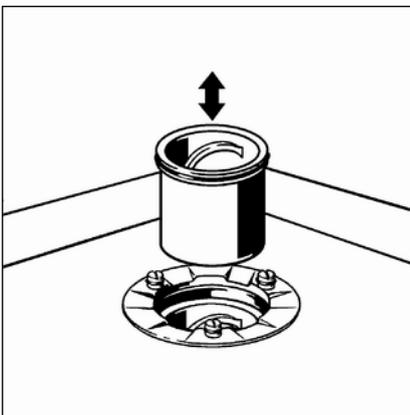
► Tauchrohr in den Geruchverschluss einsetzen.
