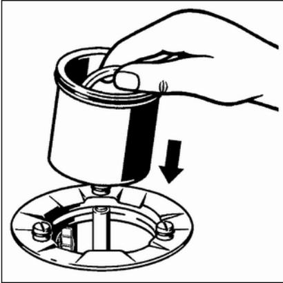
► Tauchrohr einsetzen.
