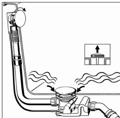
► Drehrosette nach rechts drehen.
