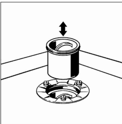
► Tauchrohr in den Geruchverschluss einsetzen.
